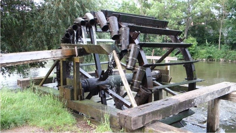
Rys. 4. Rurmus (noria) – koło wodne podsiębierne połączone z czerpakami, służące do podnoszenia wody rzecznej na wyższy poziom [16].
